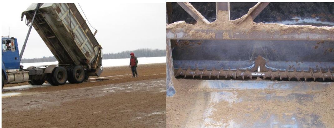
Figure 7 : Machinerie utilisée pour l'application de sable chez le producteur A et vis d'Archimède à l'intérieur de la benne du camion.
